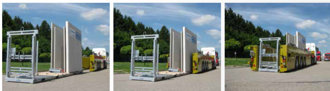
Figur 3: Lastning av kassett på bygeltrailer (Faymonville, 2016).
