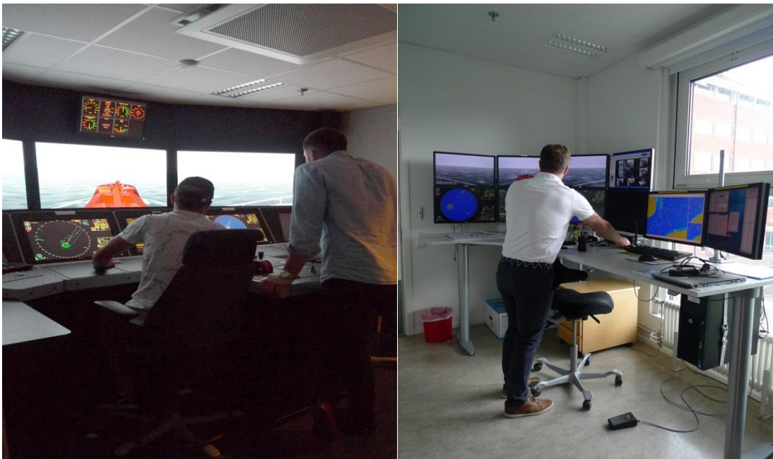
Figur 4.3.4. bryggsimulator med elever under pågående scenarioövning (vänster) och instruktörsplats med speglade operatörsskärmar, övervakningsskärmar, höj- och sänkbart skrivbord samt intercomutrustning (höger)
