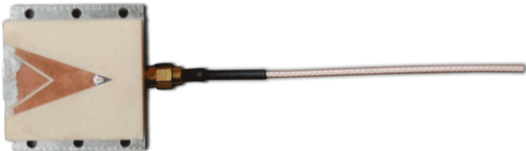
Figur 3.14: En triangulär patch-antenn med antennkabel fastkopplad. Figuren är hämtad från [6].
