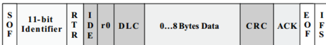
Figur 1. Bit strukturen av ett CAN-standard meddelande.
