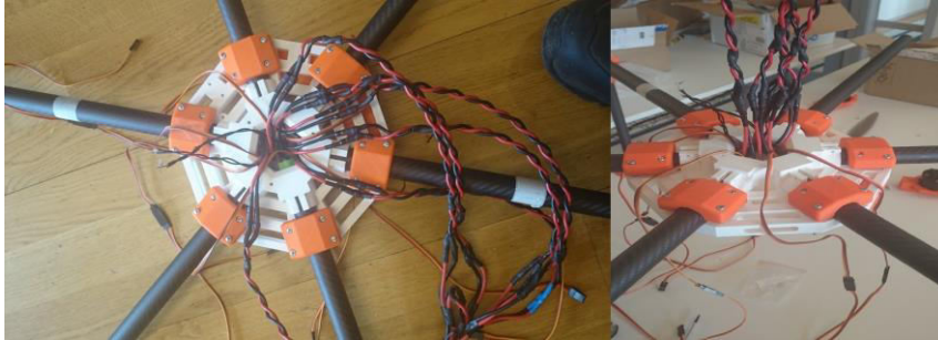
Figur 15: Drönare med kablage installerat[49].
