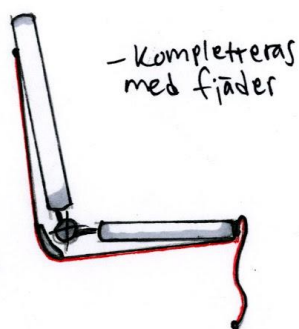
Fig. 5.13 – Skiss av hur ryggstödet kan vinklas och låsas med ett snöre.
