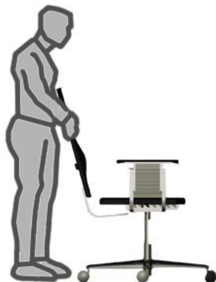
Fig. 6.15 – Demontering av ryggstödet.
