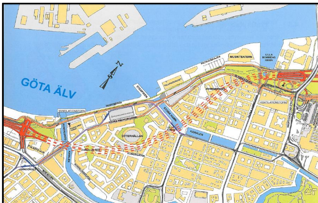
Figur 1. Illustration över Götatunnelns sträckning genom Göteborg (Vägverket region Väst, 1997). Återgiven med tillstånd
