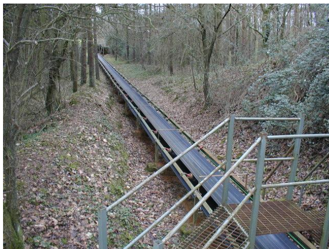
Figur 10. Ett exempel på ett öppet transportband för krossmaterial som löper genom en skog i Mottisfont i Storbritannien (Pavey, 2007). CC-BY-SA-3.0
