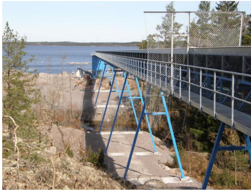
Figur 11. Exempel på bandtransportör på pelare. Foto av Kjell Windelhed. (Trafikverket, 2011d). Återgiven med tillstånd
