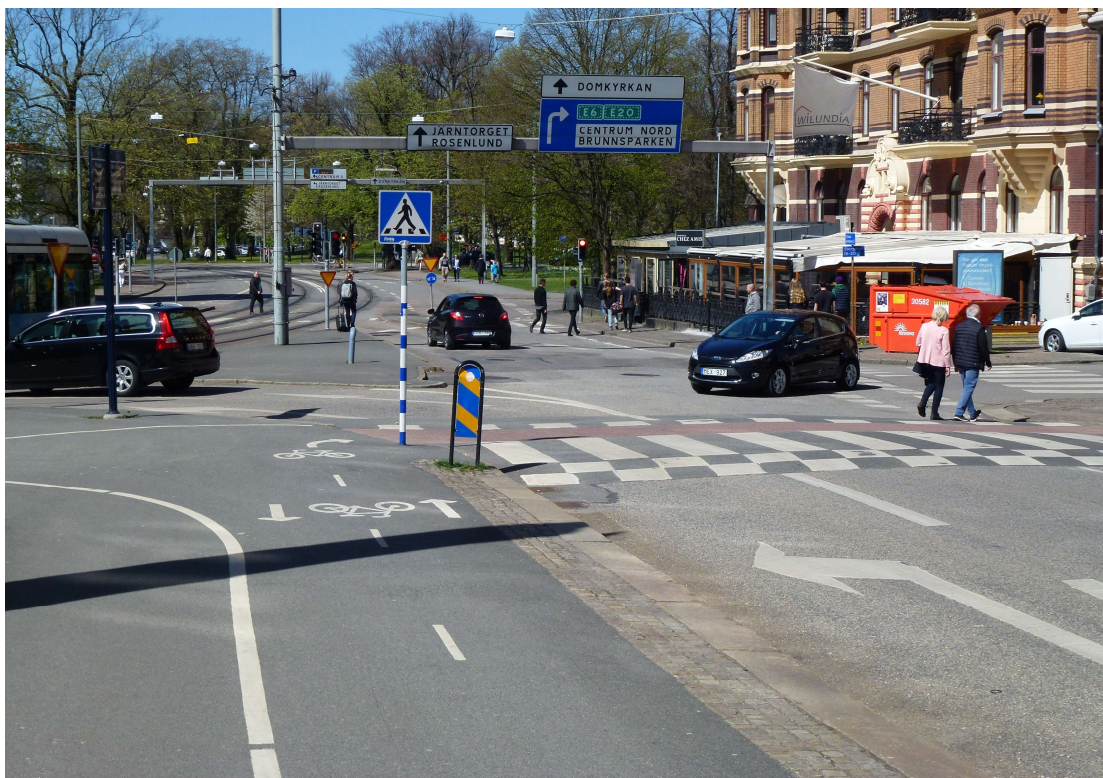
Figur 4.7 Upphöjd och rödmarkerad cykelpassage med övergångsställe.
