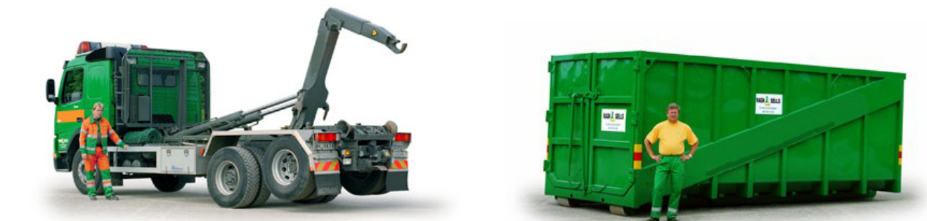
Figur 9. Bilden till vänster visar en lastväxlarbil. Bilden till höger visar en lastväxlarcontainer som rymmer 30 m 3 ( www.ragnsells.se ). Återgiven med tillstånd.
