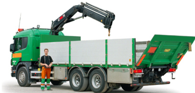
Figur 10. Bilden visar en flakbil med kran ( www.ragnsells.se ). Återgiven med tillstånd.
