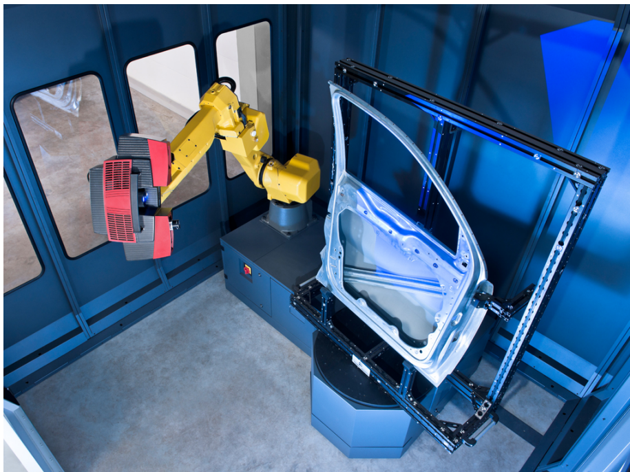
Figur 3 GOM ATOS Triple Scan 3D-skannar en bildörr (Cascade 2016)
