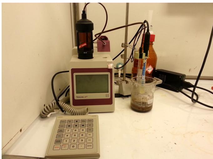
**Figure 3.2:** The TitroLine alpha titration equipment
