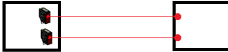
Figur 55. Två lasrar som avgör basenheternas position
