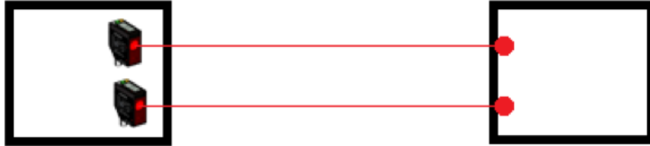
Figur F19. Lasermätning för rätt vinkel och avstånd mellan basenheterna
