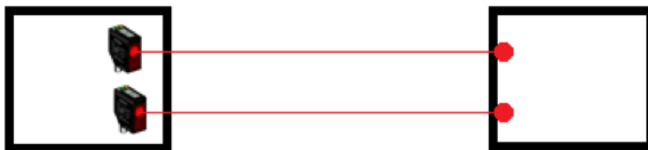
Figur 17. Lasermätning för rätt vinkel och avstånd mellan basenheterna
