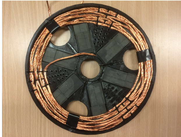
Figur 5.4: Mottagarspolen lindad med litztråd i ram skapad med hjälp av 3D-printer
