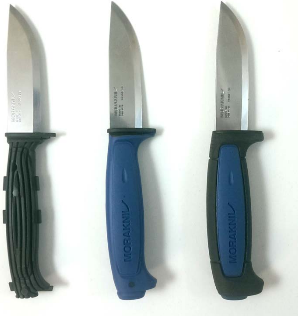
Figur 2.3 Plastskaftets utseende efter varje steg i formsprutningsprocessen
