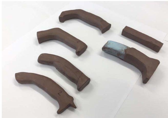
Figur 3.12 Lermodeller med olika nedböjning på skaftet
