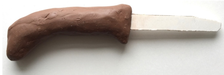
Figur 4.14 Skaft 2. Omkrets: 115 mm och längd 130 mm
