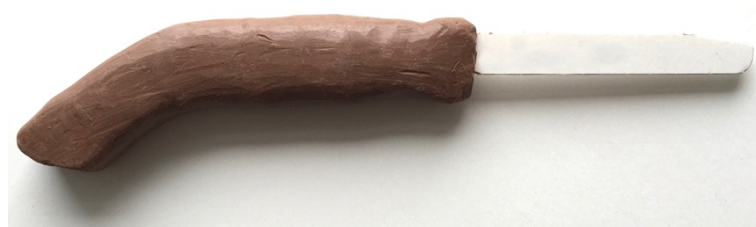
Figur 4.13 Skaft 1. Omkrets: 105 mm och längd: 160 mm
