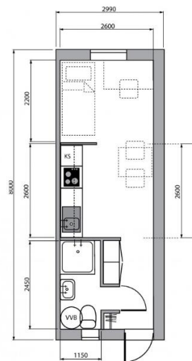
Figur 4.2. Visar planlösning för bostadsmodul 24 från modulgruppen, ej skala (Modulgruppen, 2016).
