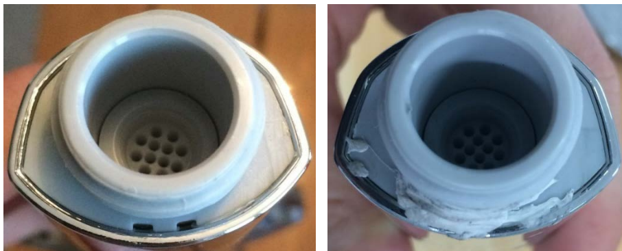
Figur 3.3. Förhindrande av luftinblandningen då den sker i duschhandtaget.
