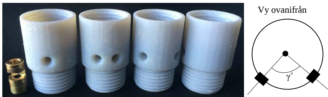
Figur 5.6. En ejektor och adapterar för undersökning av antalet lufthål, samt en principskiss över lufthålens placering.
