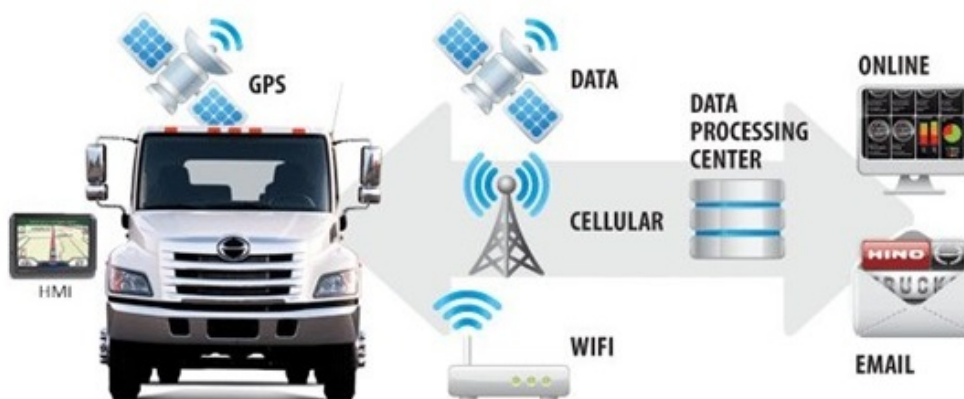
Figur 15: Visualisering av hur telematik fungerar. Data inhämtas från sensorer och GPS i bilen för att skickas till en dator. (Trackmatic.co.uk, 2016)
