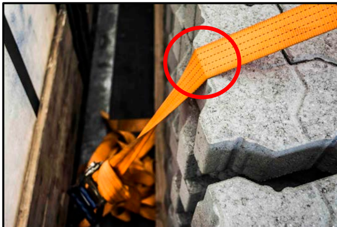
Figur 12 - Risk för skada på spännband
