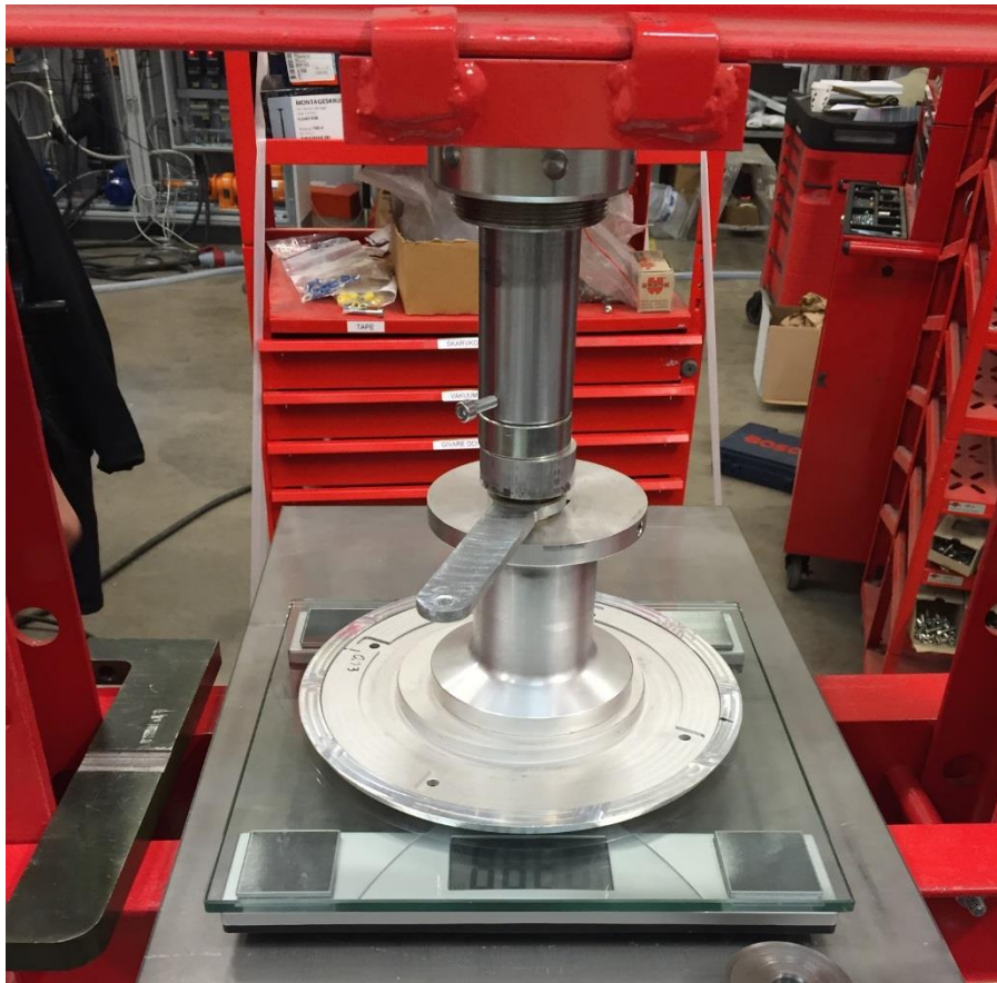
Bild 5.7 Infästningen testades i en hydraulisk press. En våg användes för att säkerställa att 100 kg uppnåddes.
