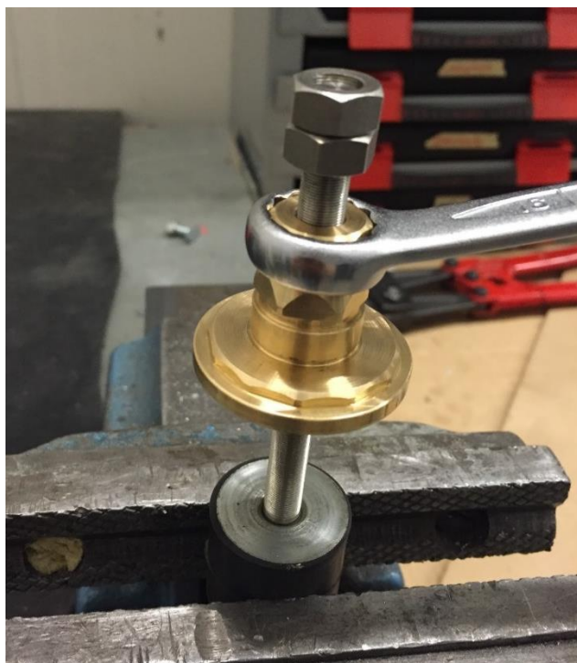
Bild 5.8 Specialmuttern roterades med hjälp av en fast nyckel
