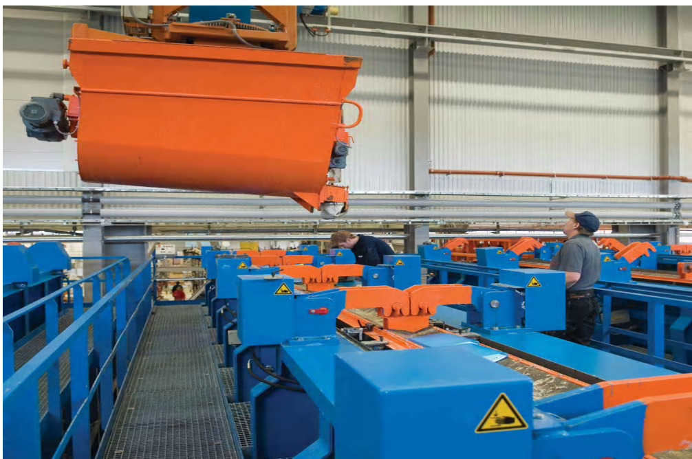
Figur 6.1 Gjutning av väggar i högpresterande betong
