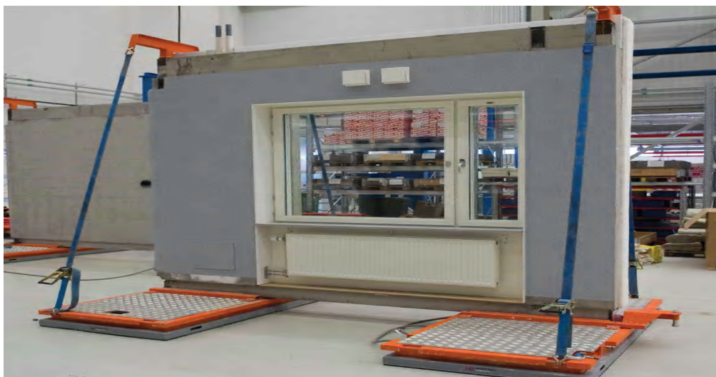
Figur 6.2 Färdig yttervägg för leverans till montageplats
