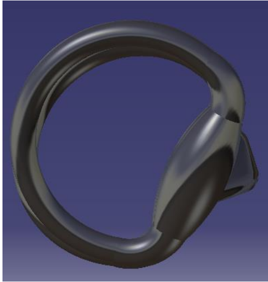
Figur 5.6 Ett bett med vinklade sidor, fasta ringar och måtten 15 mm bredd och 8 mm längd på mundelens tvärsnitt.
