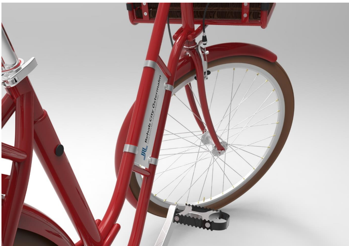
Figur 43 Matchning mellan fram- och bakpakethållarfästen
