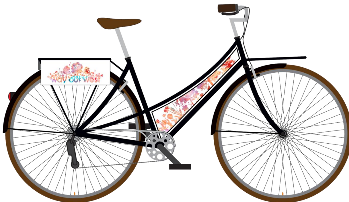
Figur 31 Konceptförslag Mixte med böjda bakre- och mellanrör.
