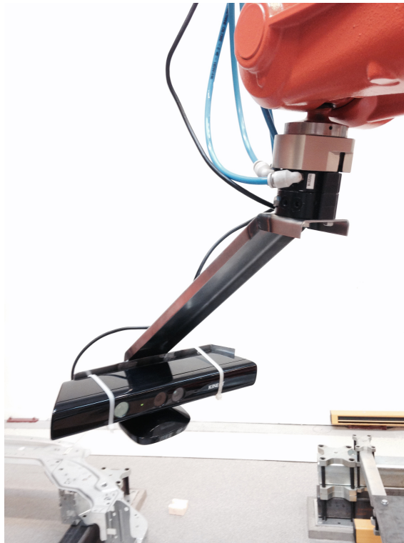
Figur 3.2: Verktyget med Kinectkameran fäst på roboten
