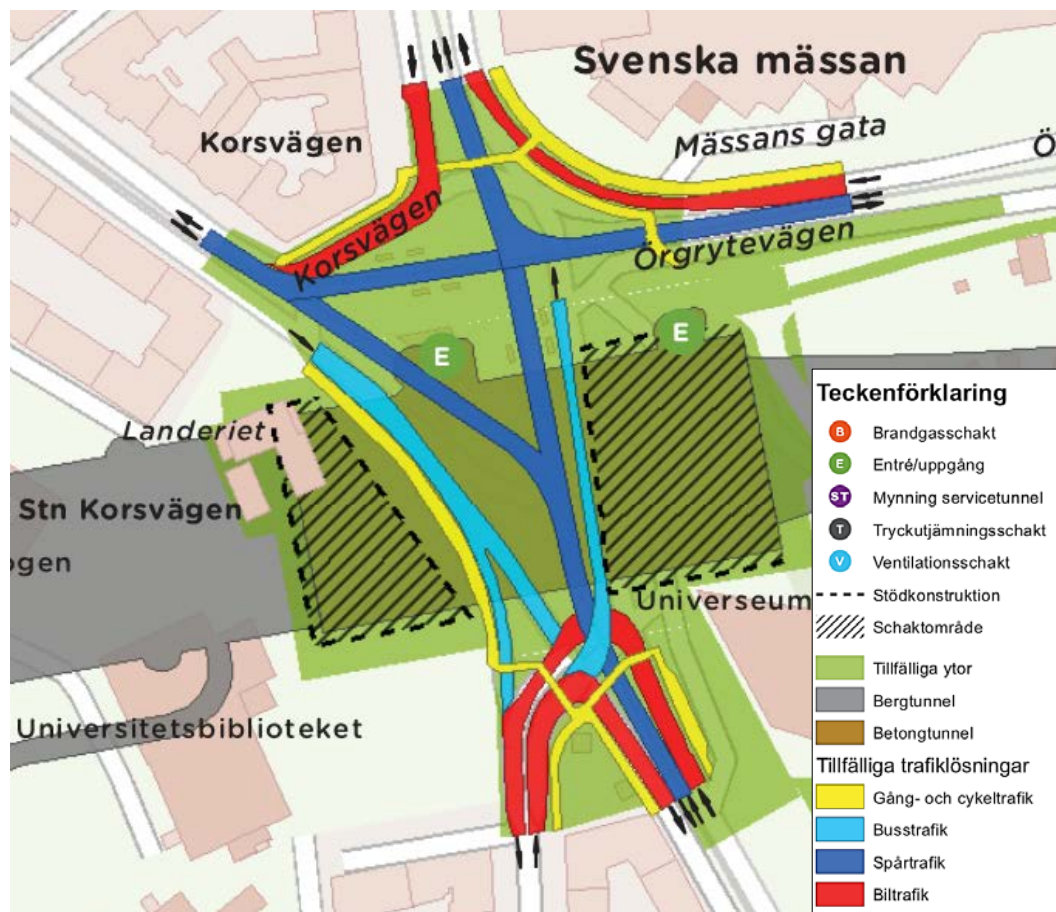
Figur 5-1: Situationsplan Station Korsvägen under byggskede 1.
