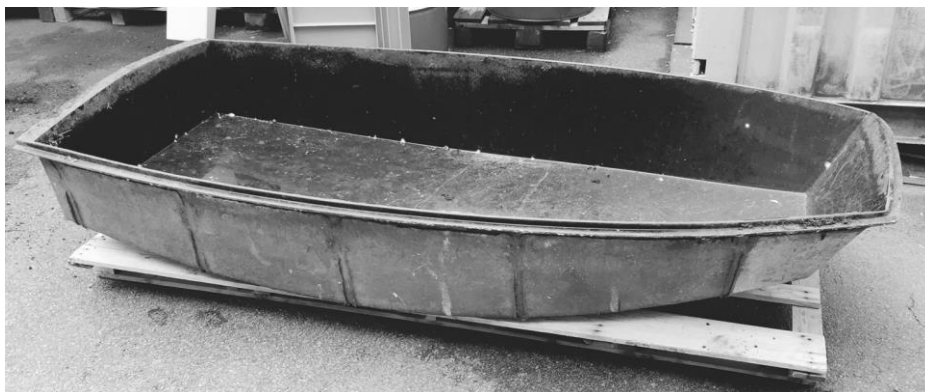
Figur 6.1: Form som används vid tillverkning av projektets optimistjolle [27]
