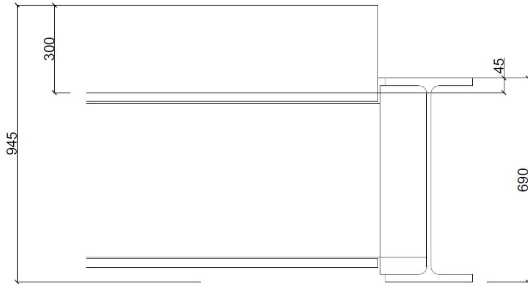
Figur 44: Sektion av bärverket med dragband, tvärbalk och betongbrobana.
