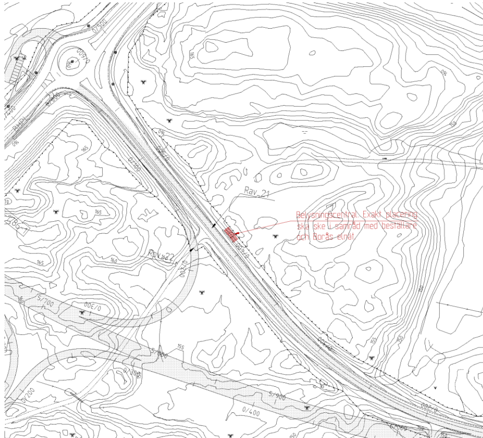
Figur (DK).4 Förslag på placering av belysningscentral i Kråkered Trafikplats. OBS storlek på belysningscentral är ej skalenlig
