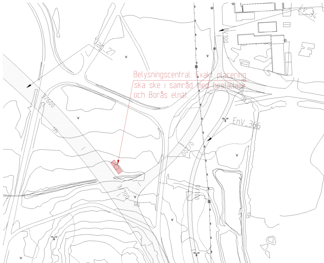
Figur (DK).3 Förslag på placering av belysningscentral i korsning Väg 27 3/700. OBS storlek på belysningscentral är ej skalenlig
