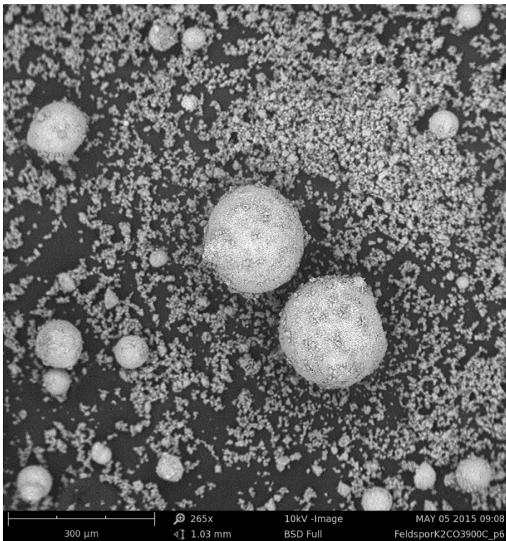
Figur 131. Svepelektronbild av Colormax Elkem med CaCO 3 , reducerad.
