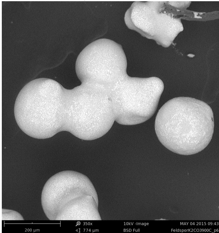
Figur 86. Svepelektronbild av M9 med K_2CO_3 , oxiderad.
