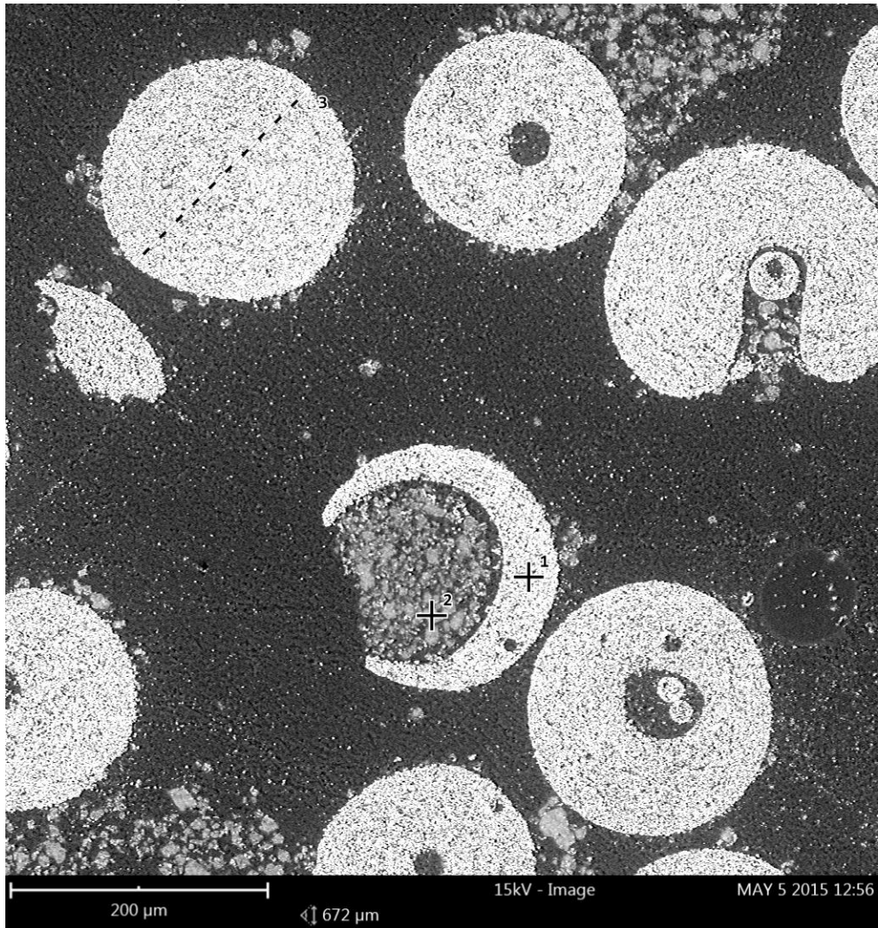
Figur 38 Svepelektronbild över tvärsnitt av M2 med CaCO 3 , oxiderad
