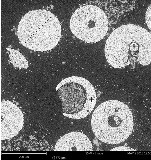
Figur 12. Bilden visar tvärsnitt av syrebäraren M2 som varit i oxiderandemiljö tillsammans med kalciumkarbonat. Elementanalys gjordes i punkterna 1 och 2 och även längs linjen 3 över en hel partikel. Elementanalysen i punkten 1 tyder på höga halter av kisel och mangan, i punkten 2 höga halter av kalcium och syre och över linjen 3 visar på jämna halter av kisel och mangan genom hela partikeln.
