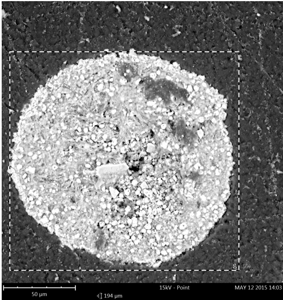
Figur 69 Svepelektronbild över tvärsnitt av M3 med K_2CO_3 , reducerad
