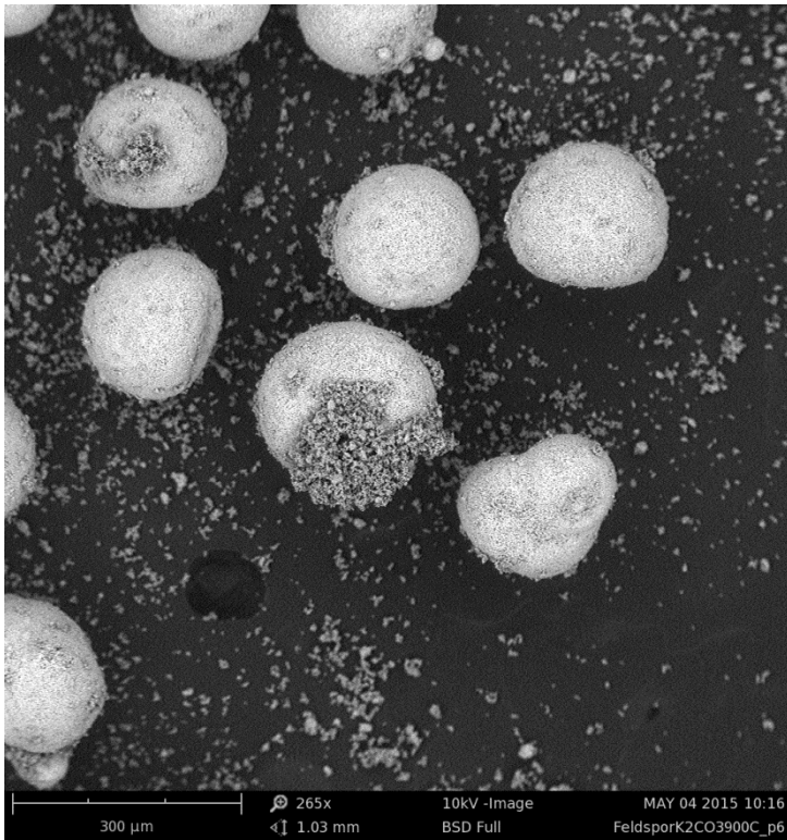
Figur 108. Svepelektronbild av M9 med \text{Ca}_3(\text{PO}_4)_2 , reducerad.
