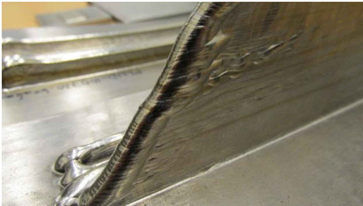
Figur 8 visar ett test som gjorts på Högskolan Väst, där en tunn och hög geometri byggts upp. I mitten av bilden kan förskjutningar mellan deponeringslager ses. Detta visar på att antingen det mekatroniska systemet eller termiska effekter har skapat en avvikelse.
