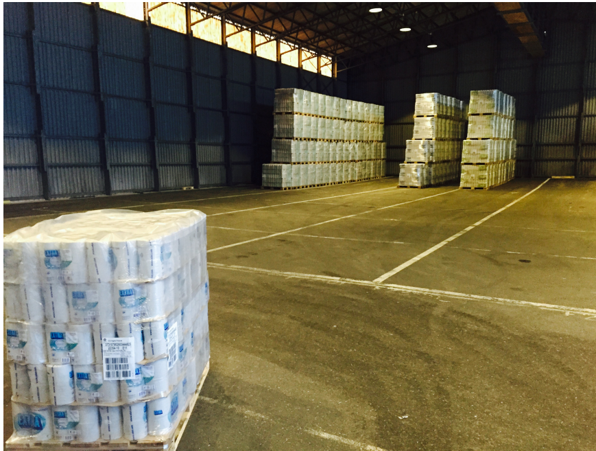
Figur 5.3: Effekten av att raderna inte är anpassade till lagringsmängden för en rad - Honeycombing.
