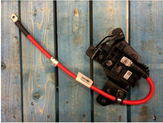
Figur 4.2. En av de vanligaste kraftkablarna med tillhörande reläbox.
