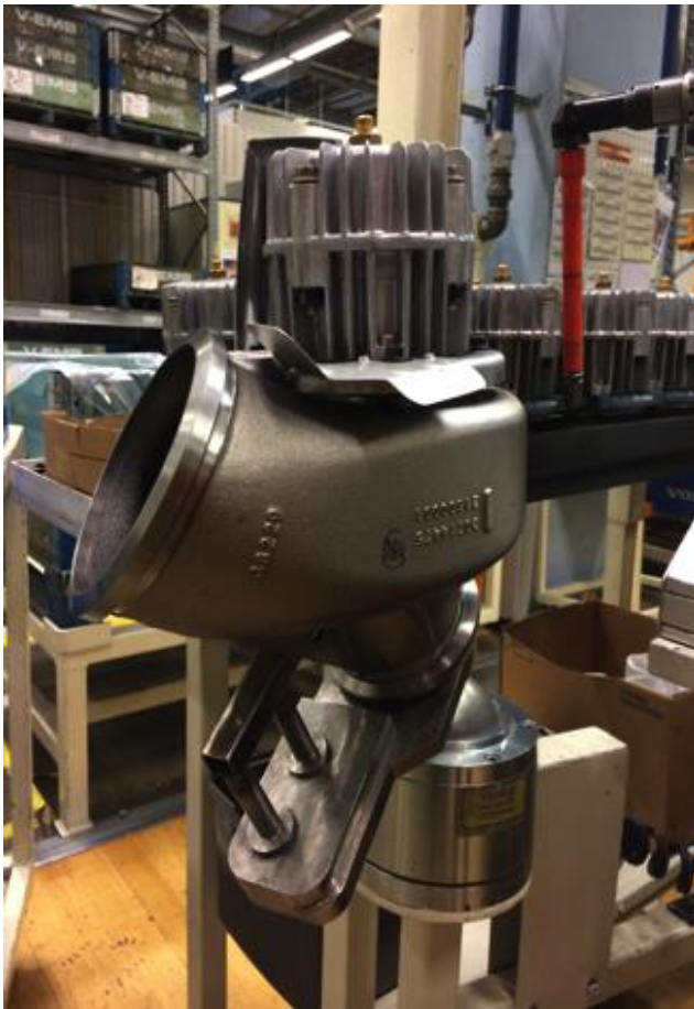
Figur 4.3. Bild på en avgasbroms som står i en fixtur på station 3.
