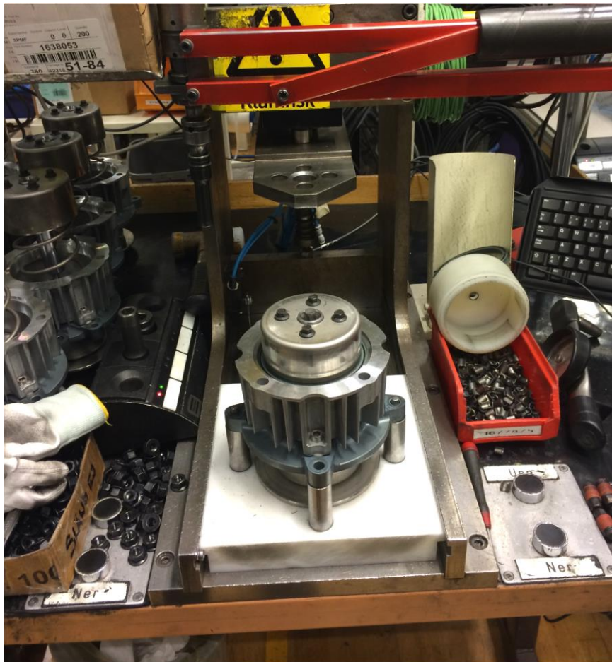
Figur 4.6. Station 2 avgasbroms. Del av komponent är placerad i fixtur.
