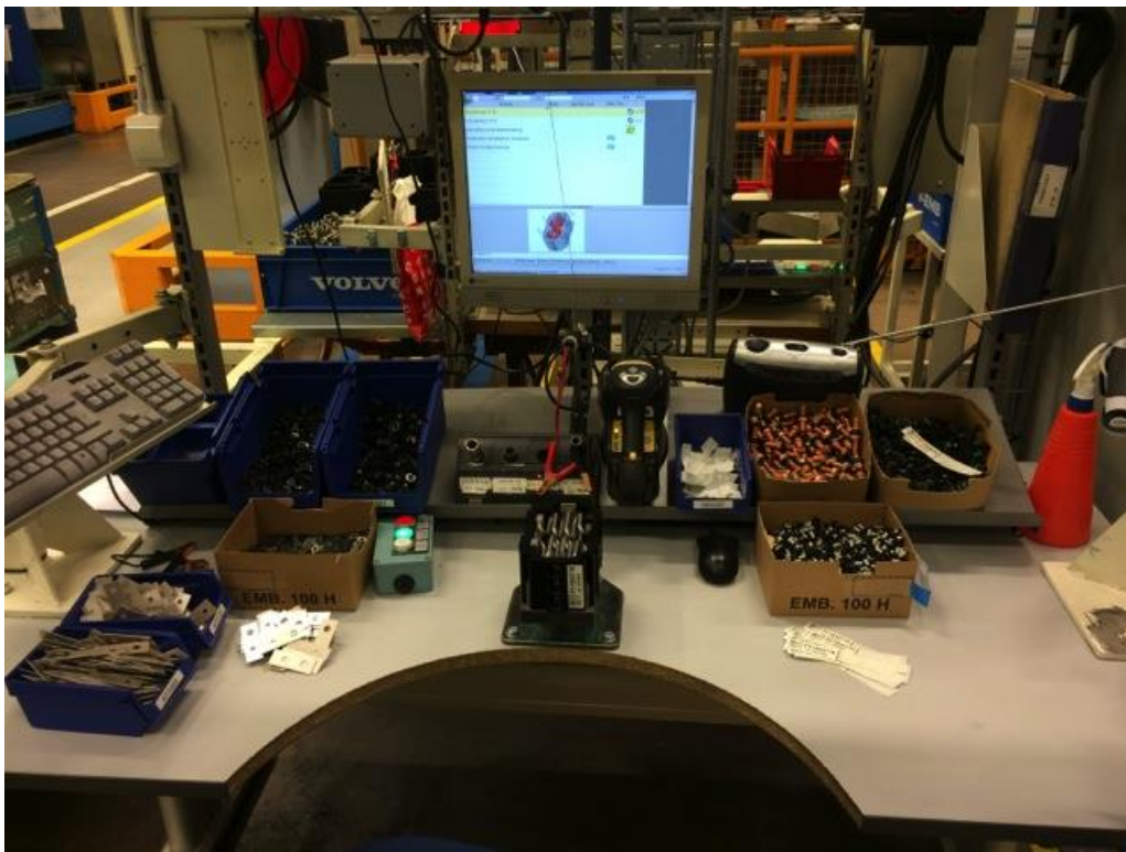
Figur 4.4. Arbetsstationen för startelement där ett startelement sitter i fixtur.
