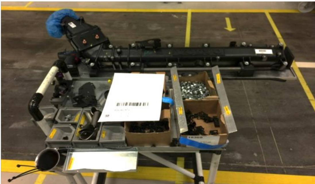
Figur 4.11. Färdigt kit med förmontage på inloppsrör som precis lämnats till montören på monteringsline.
