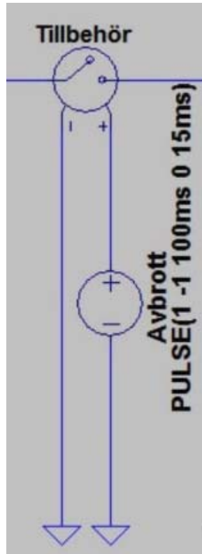
Figur 25: Ekvivalent schema för ett okritiska vanliga frekventa glapp på tillbehör
