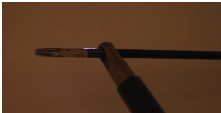
Figur 8: Ett upptäckt fel (läckströmmar)
