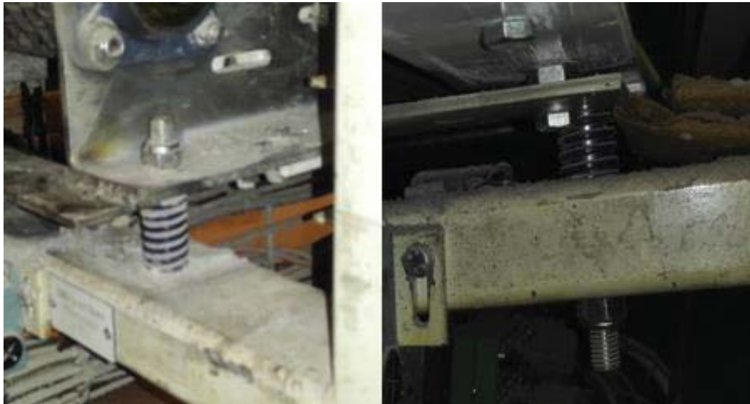
Figur 13 Så här ser fjädringarna som håller magasinbanan uppe ut. Det finns fjorton fjädringar ut med magasinbanan, sju på vardera sida. Dessa bör bytas ut om det är samma larm som uppkommer vid samma givare.
