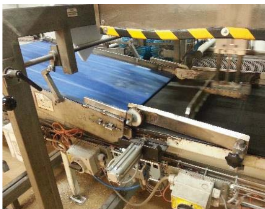
Figur 4 När plåtarna kommer till lamelltransportören passerar de scrablern där bröden åker av plåtarna till mattan och vidare till paketeringen.
