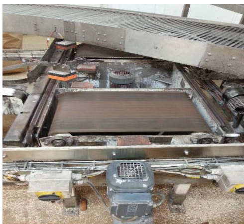
Figur 2 Vid start av produktionen körs alla plåtar ut ur magasinet vilket gör att dessa måste passera växeln. Växeln består av två mattor och två remmar. Dessa drivs av tre motorer, där varje del drivs av sin egen motor. Växeln har till uppgift att skicka plåtar som kommer ut ur ugnen till antingen uppslaget, när det är produktion, eller till plåtmagasinet när produktion ska avslutas.
