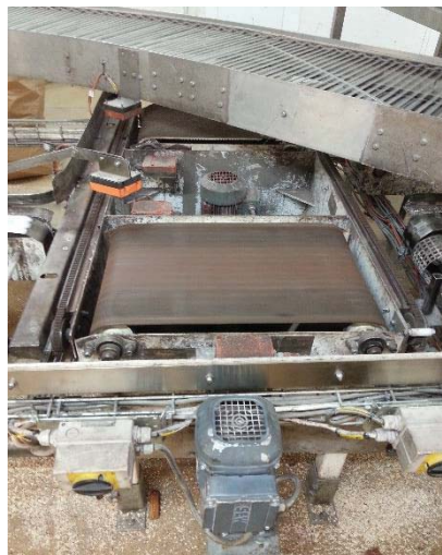
Figur 5 Växeln skickar plåtar antingen till magasinet eller till uppslaget.
