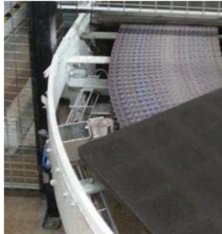
Figur 4 Ett spak som stoppar plåtar så att de får en stor lucka.
