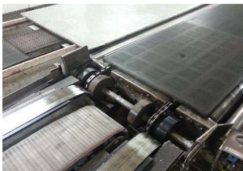
Figur 3 När plåtar kommer ur ugnen transporteras dessa av kedjetransportör och lamelltransportör.
