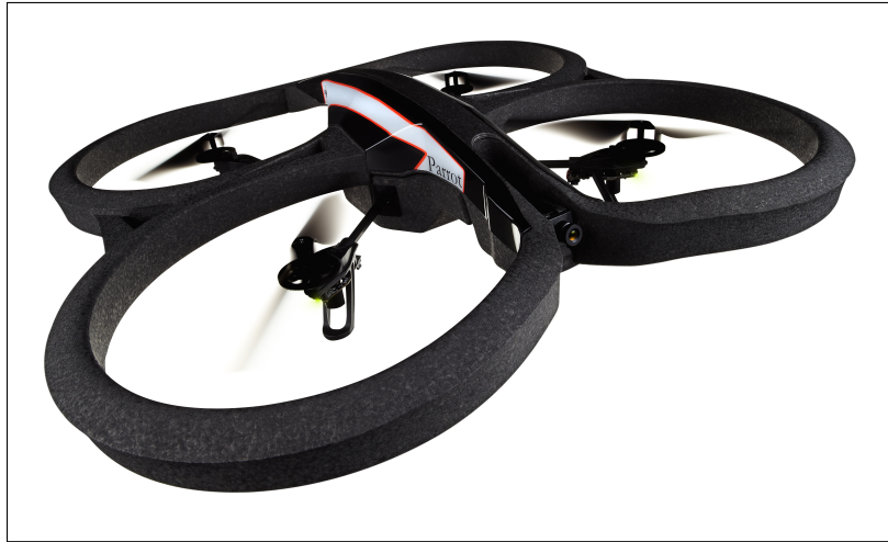
Figur 2.2: Quadrocoptern AR.Drone 2.0 med sitt skyddande hölje av cellplast påmonterat. Publicerad med tillstånd av företaget Parrots svenska importör Ingenjörfirman M Sjöberg AB.
