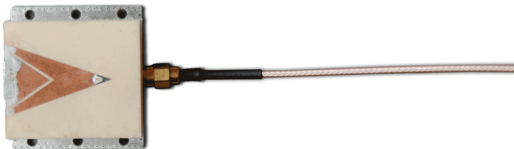
Figur 3.2: En av de triangulära patch-antennerna med fastkopplad antennkabel
