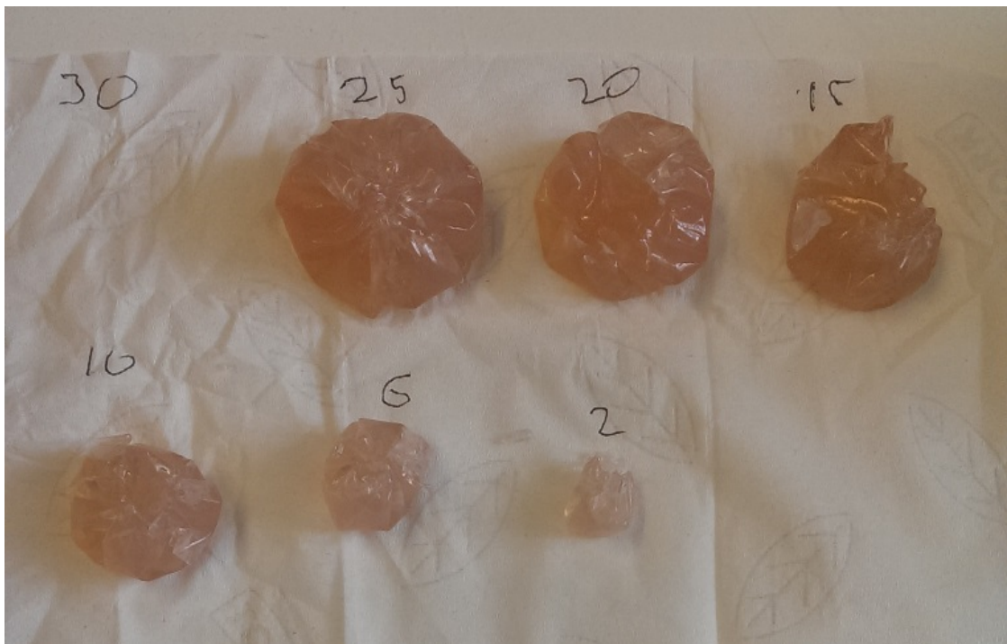
Figur 3.10: De fasta blodfantomerna som användes för mätningar på lårfantomen. Storlekar som användes i mätningar var 2 ml, 6 ml, 10 ml, 15 ml, 20 ml, 25 ml och 30 ml
