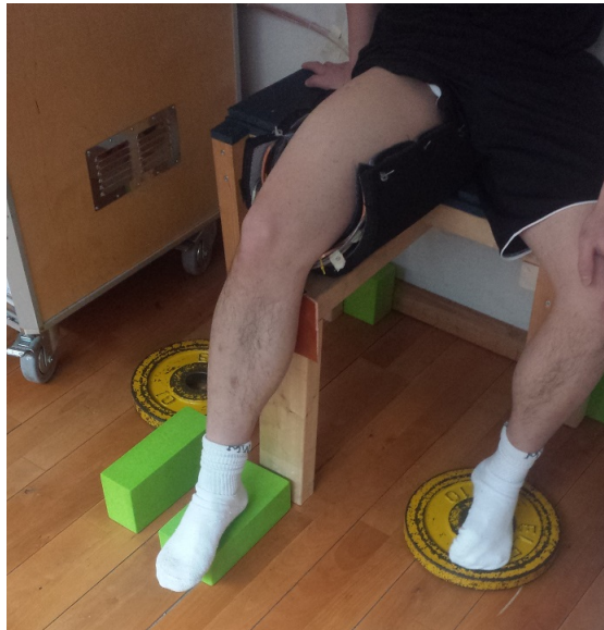
Figur 3.6: Testperson som sitter med ena låret i benskenan. Stöd placerades under foten för att avlasta benet
