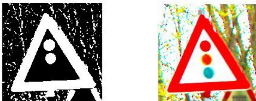
Figur 4.9: Exempel på hur applicering av NMI för att hitta röda pixlar. Höger bild är standardbilden medan vänster bild har applicerats med värdeskalning i NMI.
