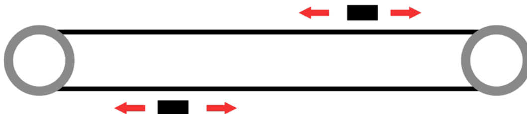
Figur 2 Rörelsemönster för reversibelt system
