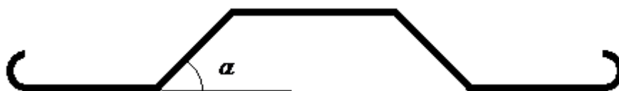
Figur 4.3. J-bygelns utformning med vinkeln \alpha mot plattans plan.
