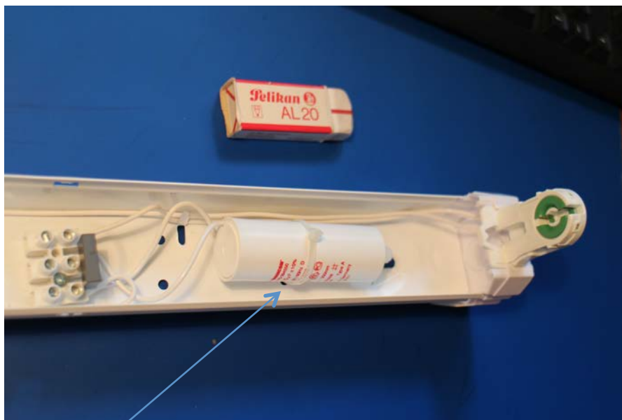
Bild: Kondensator för faskompensering (cirkulärt tvärsnitt)
