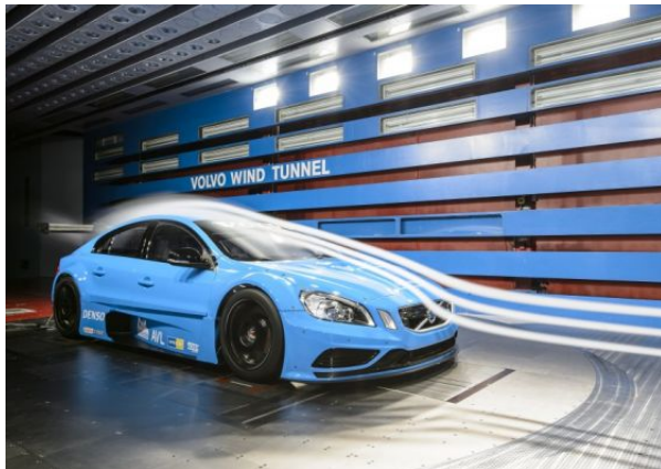
Figur 2.3: En Volvo S60 Polestar i vindtunneln, med vit rök som strömningsindikator [4].
