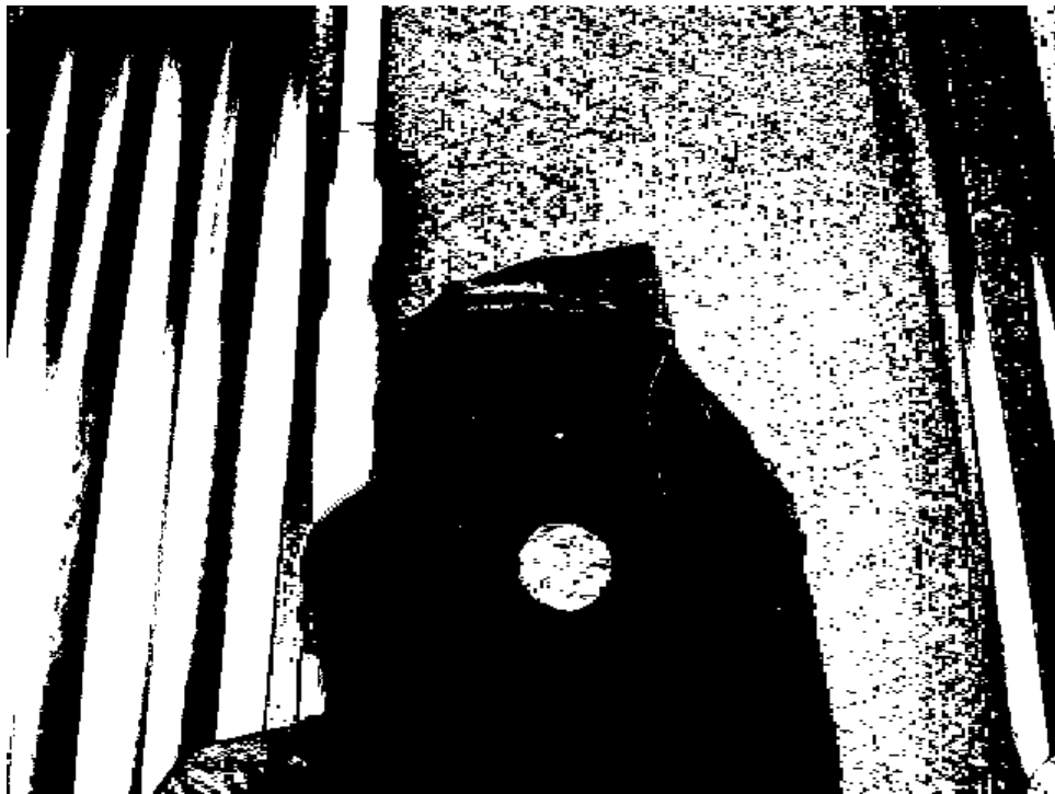
Fig. 9: Filtrerad bild före morfologiska operationer. Notera att det vita fältet som representerar objektet som söks även innehåller enskilda svarta bildpunkter vilket inte gör detektion möjligt.
