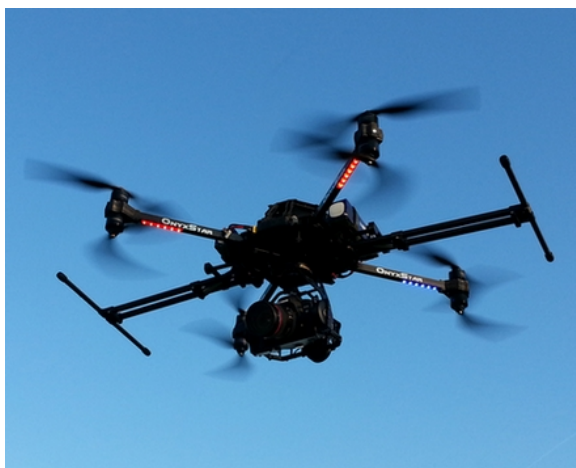
Fig. 1: En typisk utformning av mindre, radiostyrd kvadrokopter. Denna modell har en kamera monterad på undersidan för att ta flygfoto och ett uppfällt landningsställ. Extern utrustning likt dessa är något som de flesta radiostyrda kvadrokoptrar stödjer. Från [17], CC-BY-SA.
