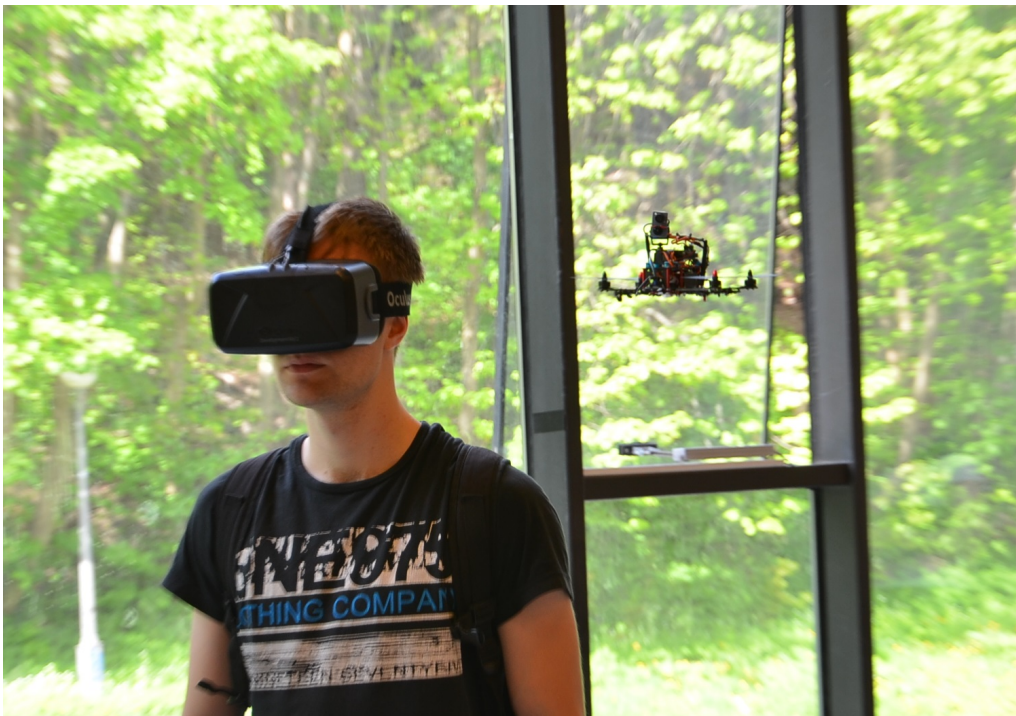
Fig. 5: En bild av hur det kan se ut när systemet används. Användaren har på sig en huvudmonterad skärm och kvadrokoptern flyger bakom användaren.
