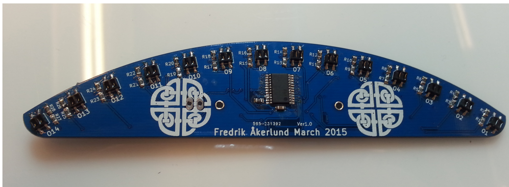
Figur 2: Walknuts specialbeställda givarstrip
