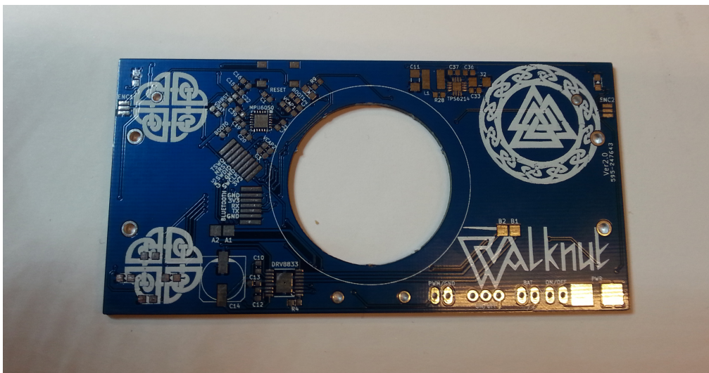
Figur 12: Mönsterkortet i fysisk form med det cirkelformade hålet utskuret, dock utan några pålödda komponenter
