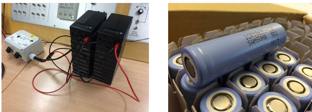
(a) Två batterimoduler och relälådan. (b) Lithiumjon-celler.
