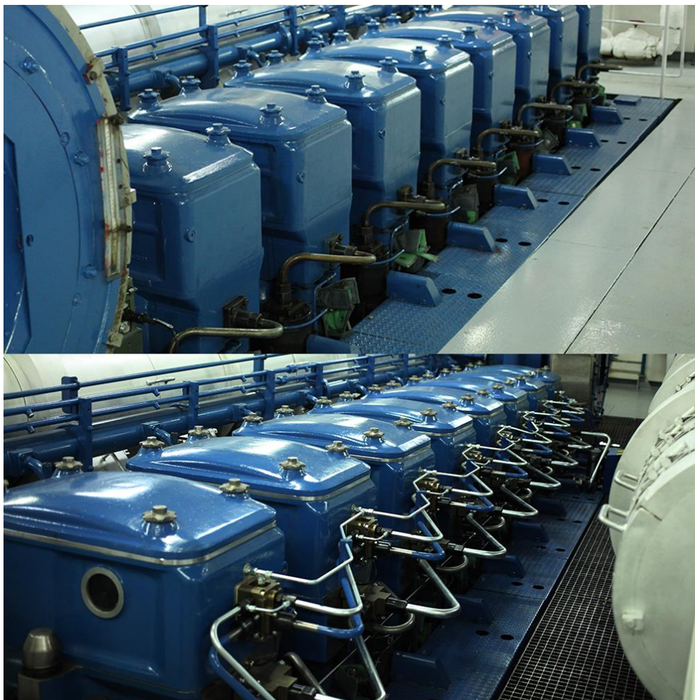
Figur 5. En ordinarie och en ombyggd huvudmaskin på Stena Germanica.
