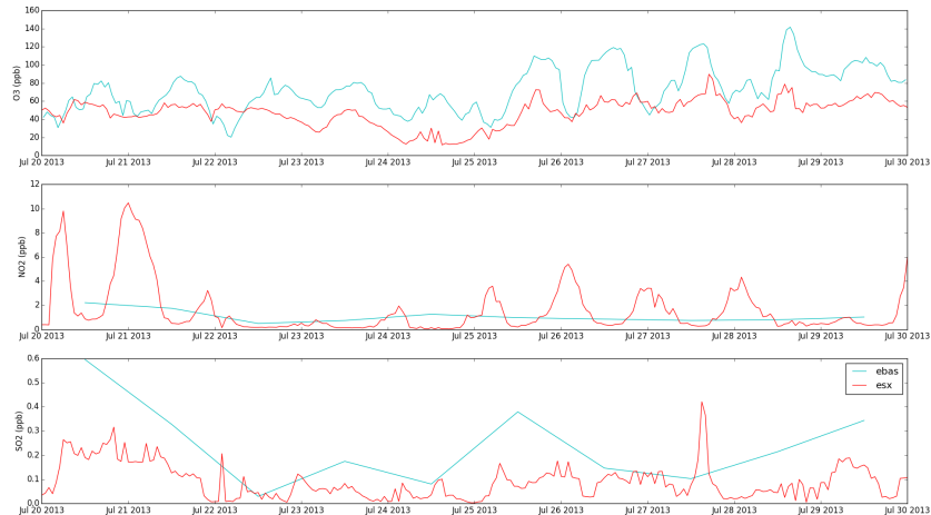
Figur 12: Jämförelse mellan koncentrationer av ozon, kvävedioxid och svaveldioxid som uppmätta av mätstationen Råö och som beräknade med ESX utifrån sjudagarstrajektorier med data för varje timme.
