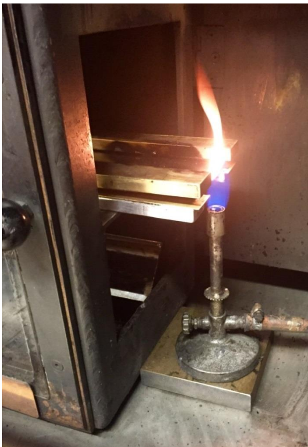
Figur 3.13 Antändning av provmaterial
