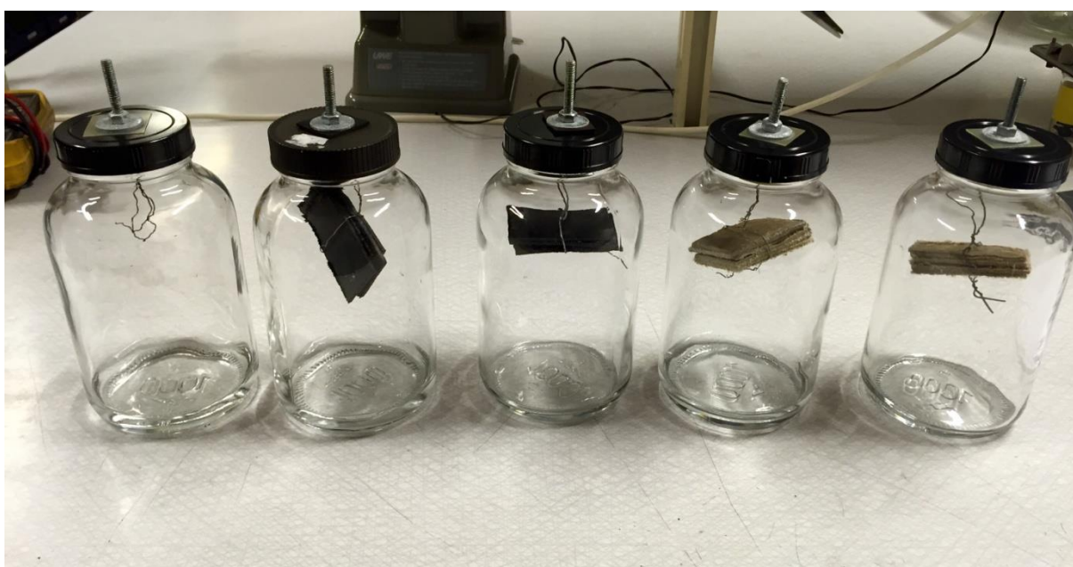
Figur 3.9 Provkärl med provbitar för de olika materialen samt nollprov längst till vänster.
