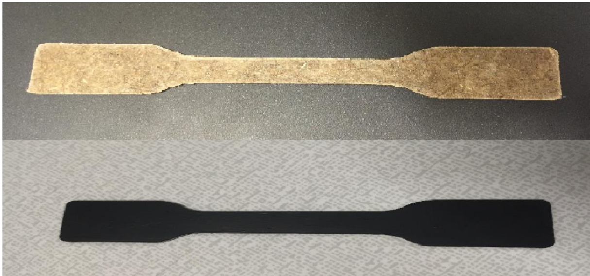
Figur 3.10 Utstansade dragprovstavar för kompositmaterial och ABS.
