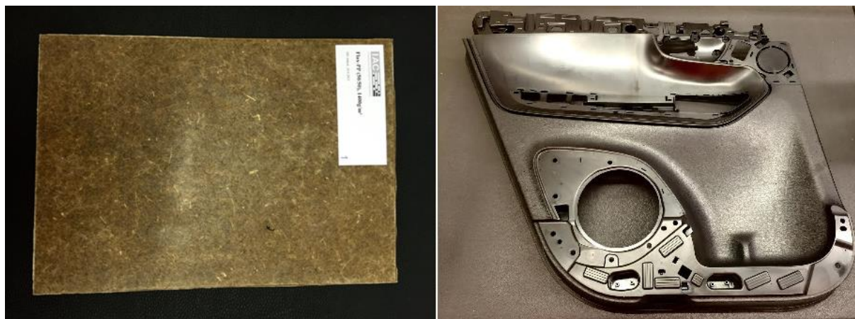
Figur 3.1 Kompositmaterial med 50% lin och 50% PP och befintlig dörrpanel från XC90 av ABS från produktion.
