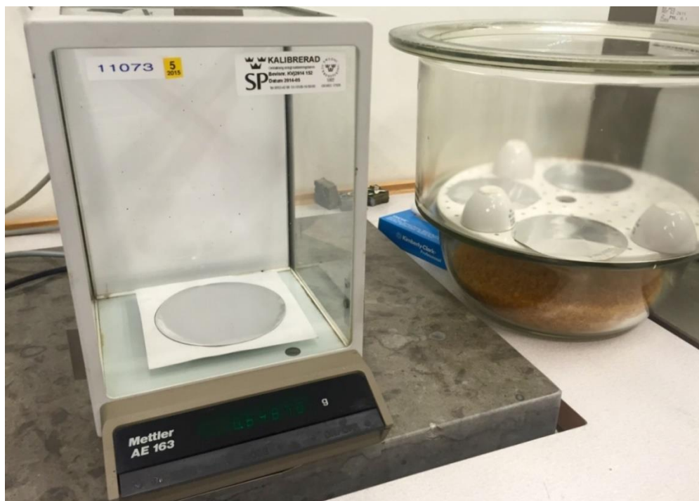
Figur 3.7 En noggrann våg som mäter fukten som finns kvar på folien.
