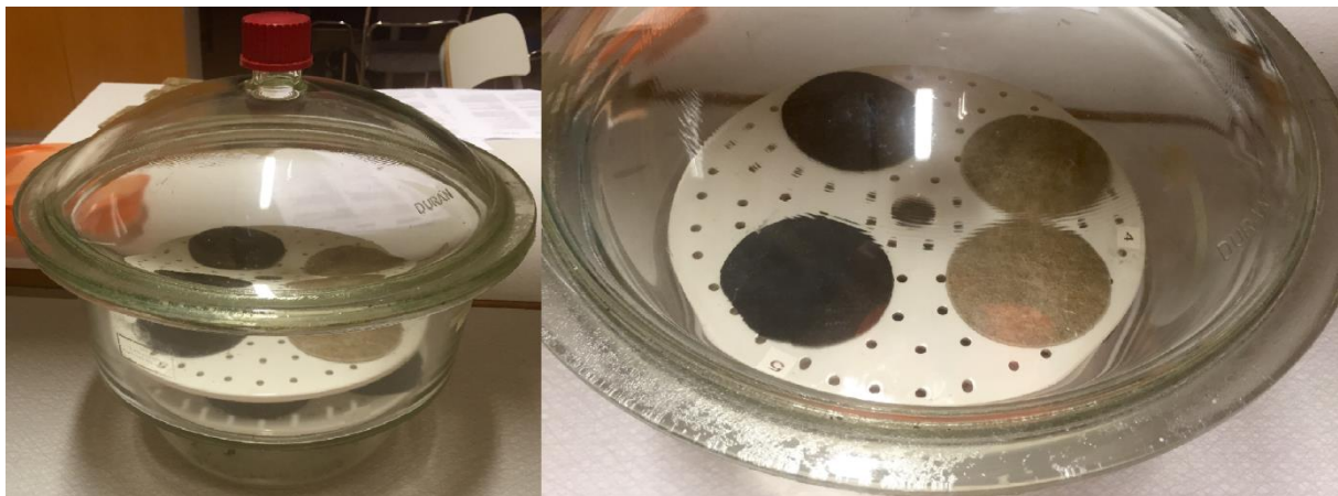
Figur 3.6 Torkning av provbitarna i exsickatorn sker i 24h
