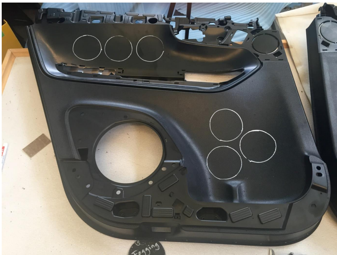
Figur 3.3 ABS dörrpanel från produktion med utritade provbitar på räfflat och blankt underlag
