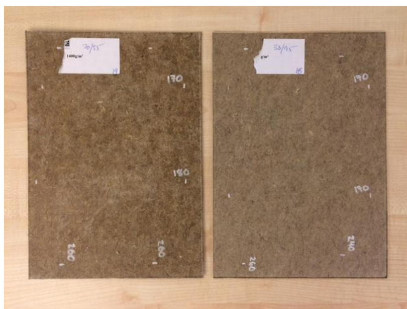
Figur 4.1 Färgskiftningarna som har uppstått hos kompositmaterialet under provtiden. Till vänster ses prov nr 19 och till höger prov nr 18
