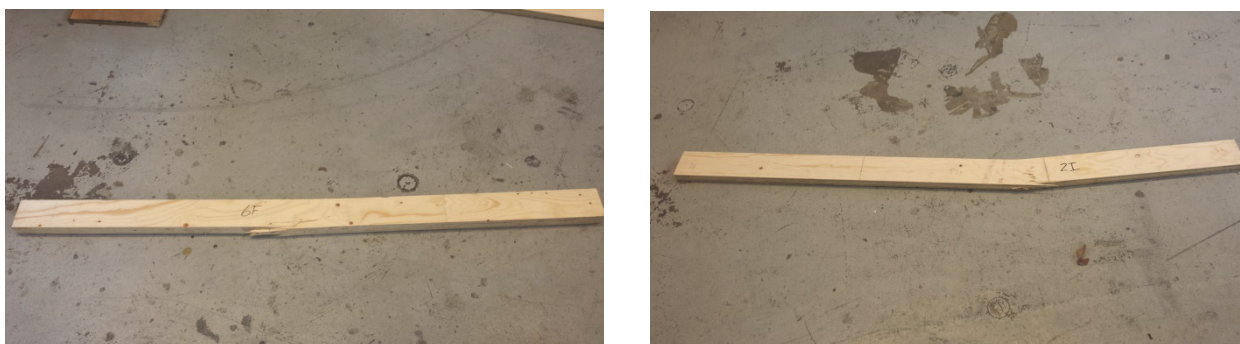
Figur 3.8: Typiska brott för typ 2 (vänster) och typ 6 (höger)
