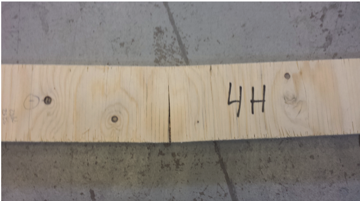
Figur 3.13: Böjbrott i provkropp 4H
