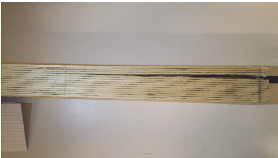
Figur 3.7: Skjuvbrott i provkropp 5D
