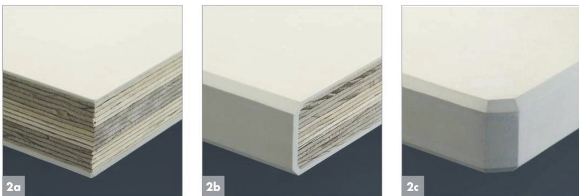
Figur 2.8: LVL inklädd i plast (ASSYX GmbH & Co., 2006)
