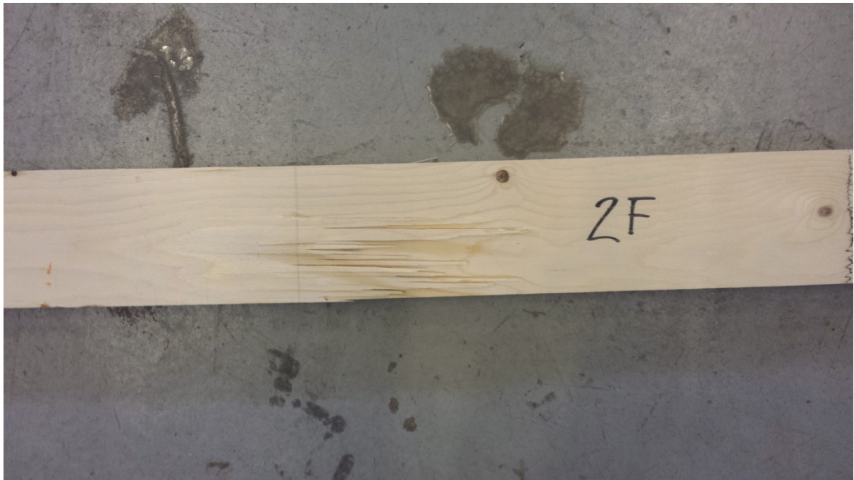
Figur 3.9: Böjbrott på tvären i provkropp 2F
