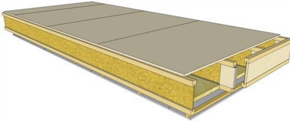
Figur 2.7: Bjälklag av lättviktsbalkar (Masonite Beams, 2014)
