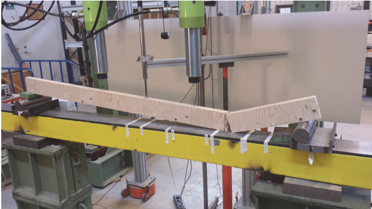
Figur 3.12: Typiskt brott för typ 4
