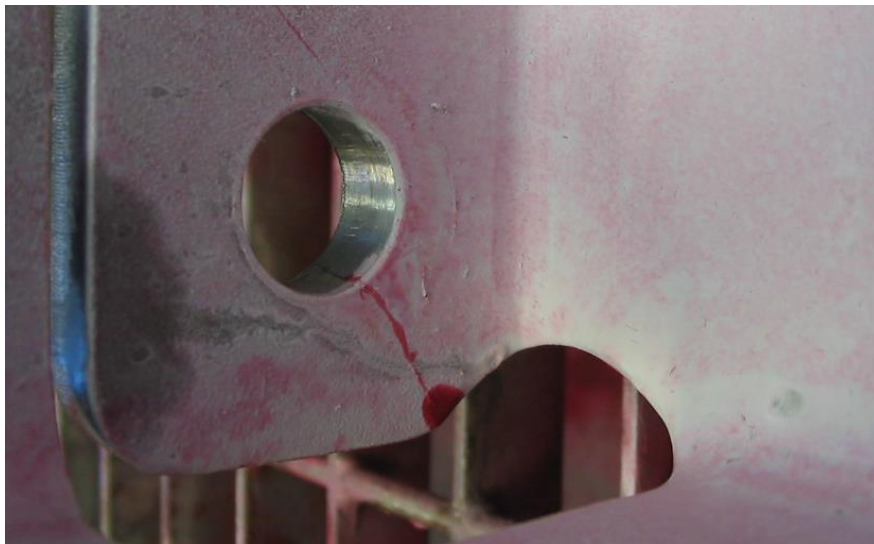
Figur 2.9 Fotografi av spricka efter utmattningsprov, synliggjord med penetrantvätska
