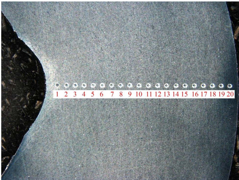
Figur 6.6 Numrerade avtryck efter hårdhetsprov
