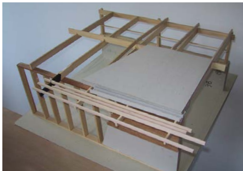
Modellstudie över takkonstruktion, skala 1:20
