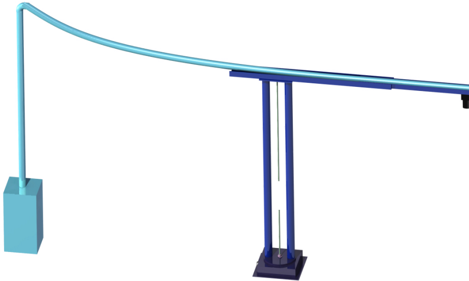
Figur 7.3 Betongskrivare med slang och pump
